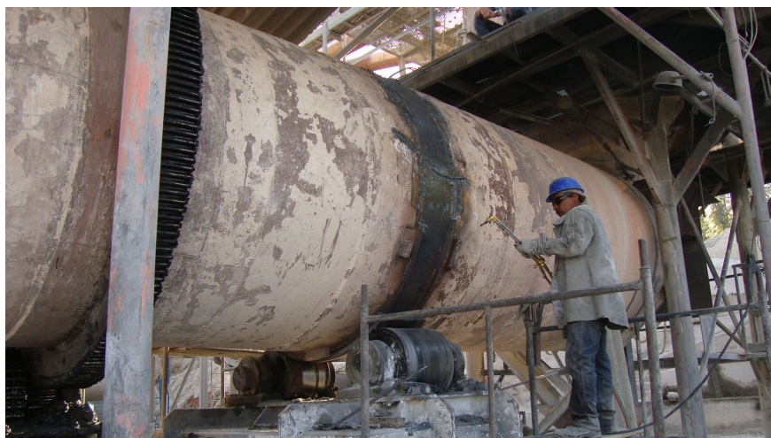
Figura 4: Manutenção da pista no forno rotativo da empresa Tecnocal Ltda Fonte: Dados da pesquisa aplicada.
