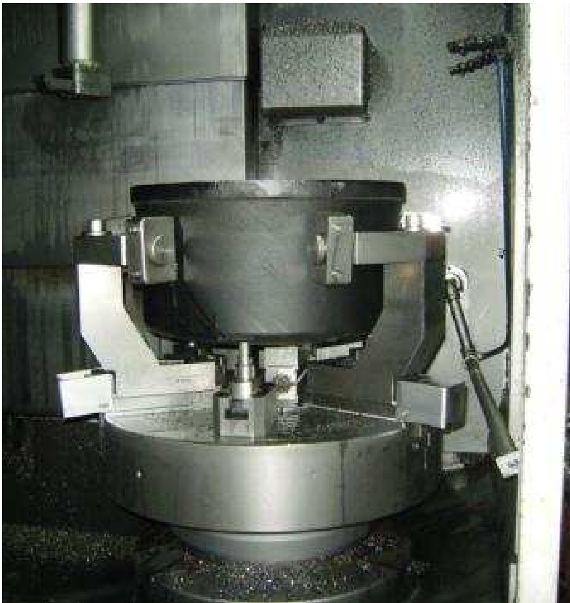
FIGURA 7 – Ilustração da aplicação da fixação do tambor na castanha.
