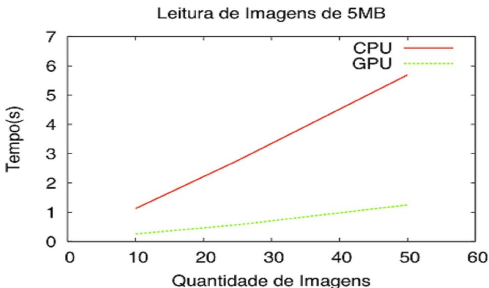
**Figura 3** - Resultados da leitura de imagens de 5 MB utilizando o CPU e o GPU
