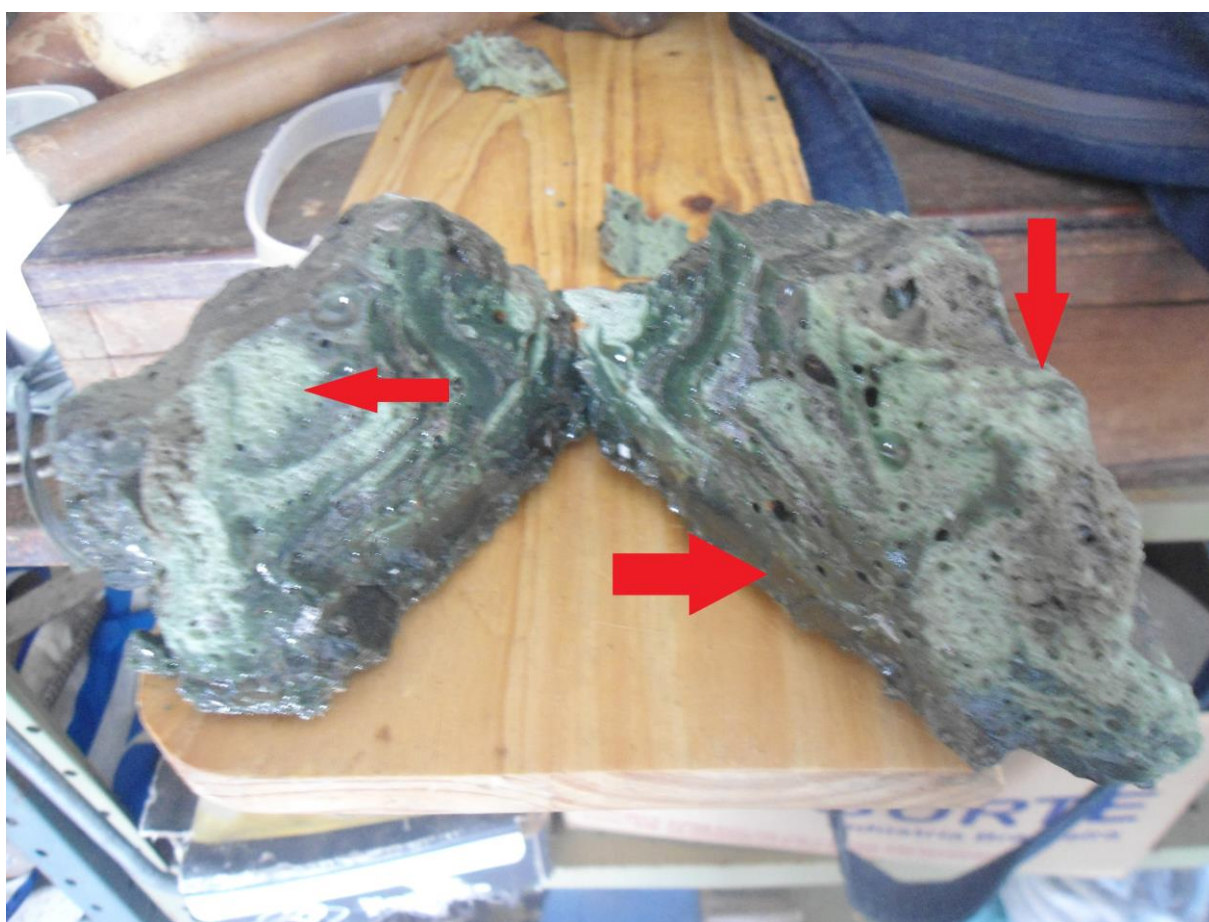
Figura 7: Partes da escória com diferentes índices de vazios.
