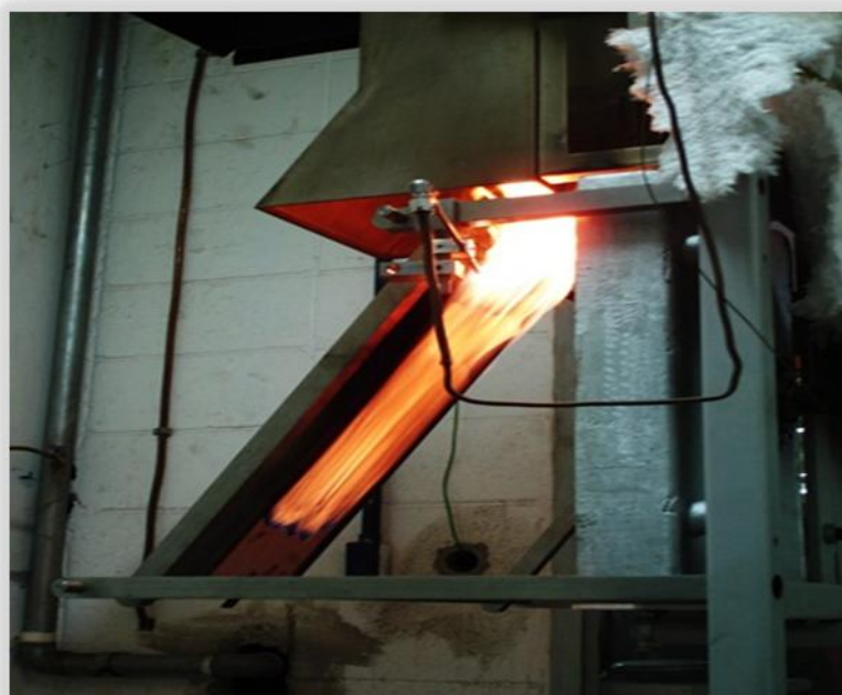
Figura 10 – Método de ensaio do painel radiante
