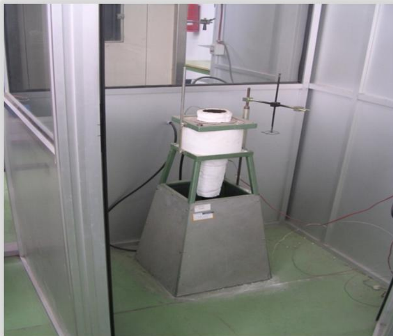
Figura 7 – Forno para ensaio de incombustibilidade
