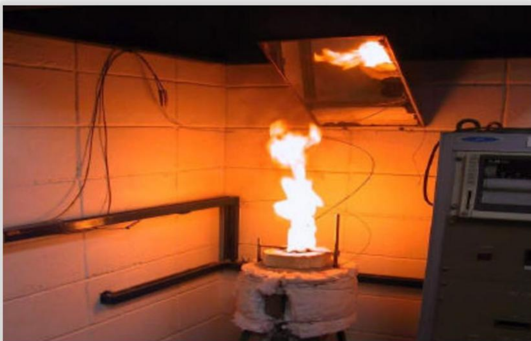
Figura 8 – Forno para ensaio de incombustibilidade durante ensaio
