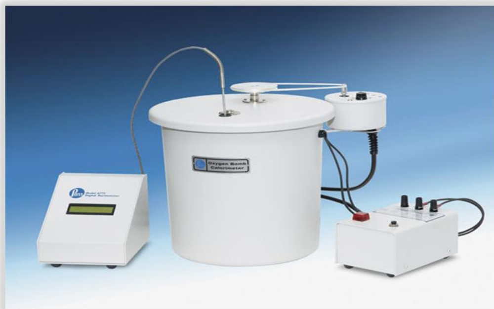
Figura 11 – Bomba calorimétrica Parr modelo 1341
