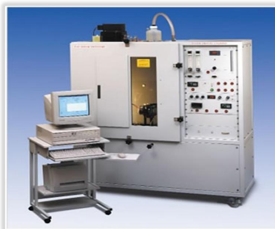
Figura 12 – Câmara de densidade de fumaça
