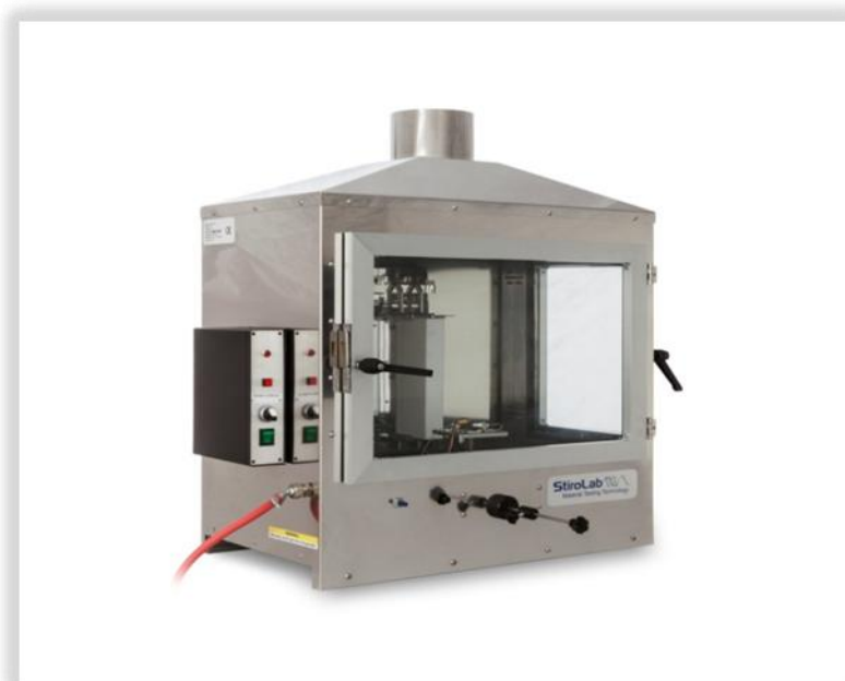
Figura 9 – Câmara para teste de inflamabilidade
