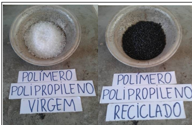
Figura 15 – Polímeros de polipropileno virgem e reciclado
