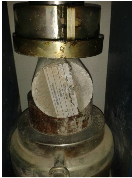
Figura 18 – Ensaio de tração por compressão diametral
