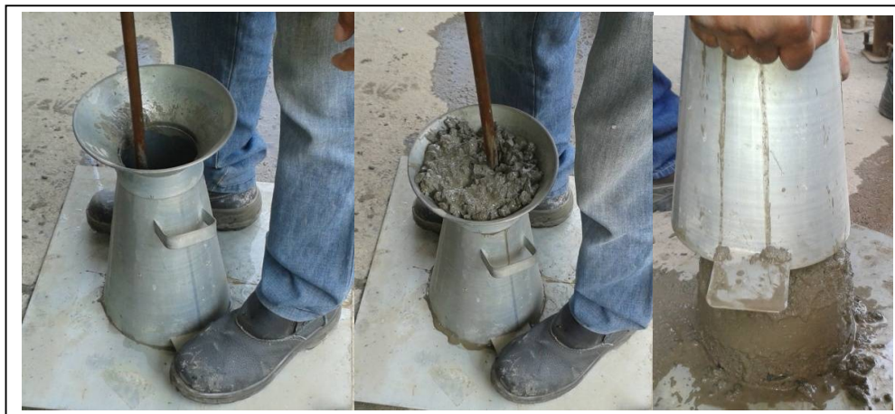
Figura 16 – Ensaio de abatimento do tronco de cone – Slump Test
