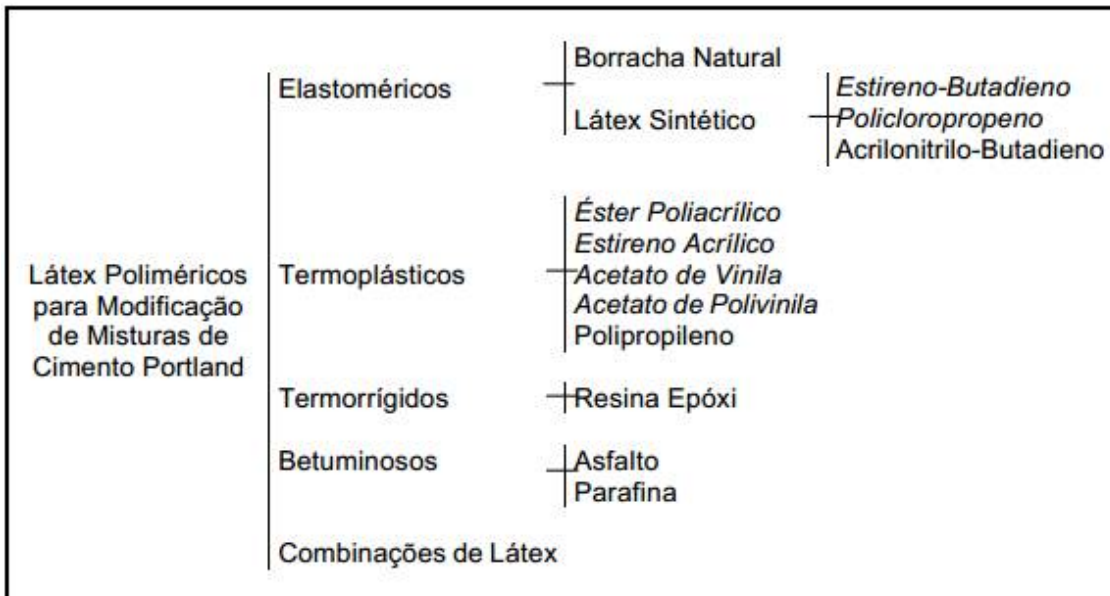
Figura 9 – Principais látex usados com o cimento Portland como aglomerantes
