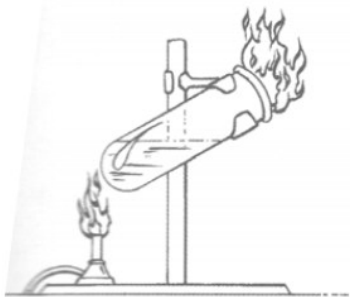
Figura 4 – Esquema ilustrativo do ponto de ignição.
