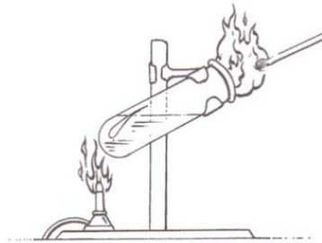
Figura 3 – Esquema ilustrativo do ponto de combustão.
