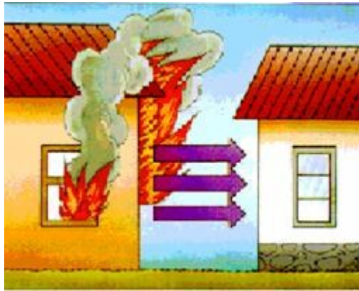
Figura 7 – Esquema ilustrativo de transmissão de calor por irradiação
