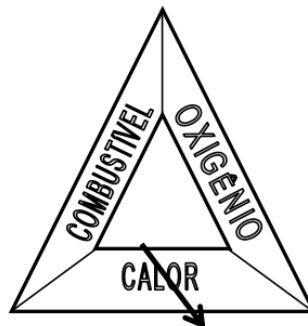
Figura 8 – Método de extinção por resfriamento.
