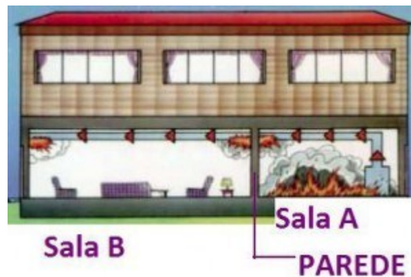
Figura 6 – Esquema ilustrativo de transmissão de calor por condução.
