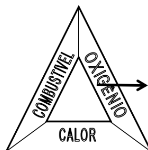
Figura 9 – Método de extinção por abafamento.
