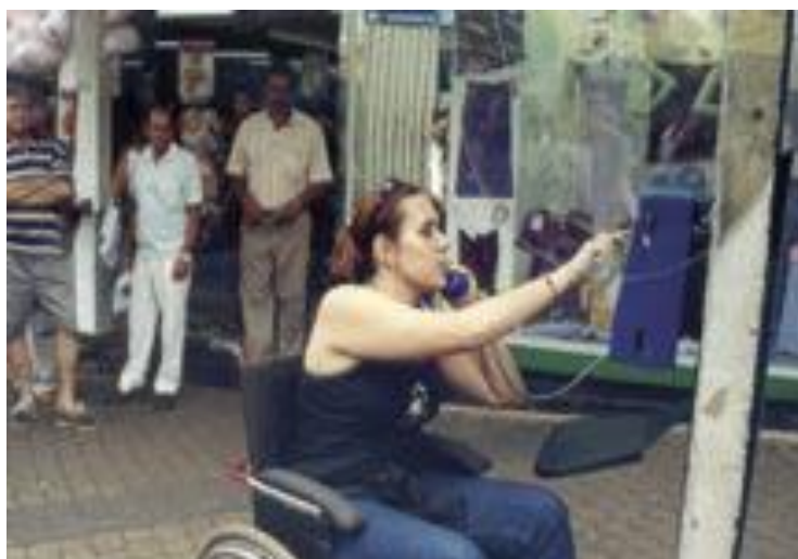
Figura 15 – Exemplo de Desenho Universal: telefone público instalado em determinada altura que atende tanto um cadeirante quanto uma pessoa em pé
