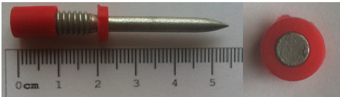
Figura 28 - Parafusos utilizados como chumbadores
