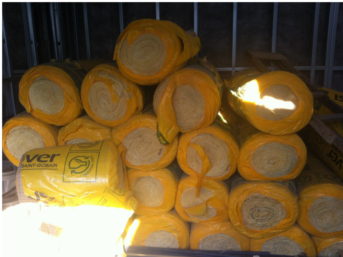
Figura 42 - Estocagem do isolante termoacústico - lã de vidro.
