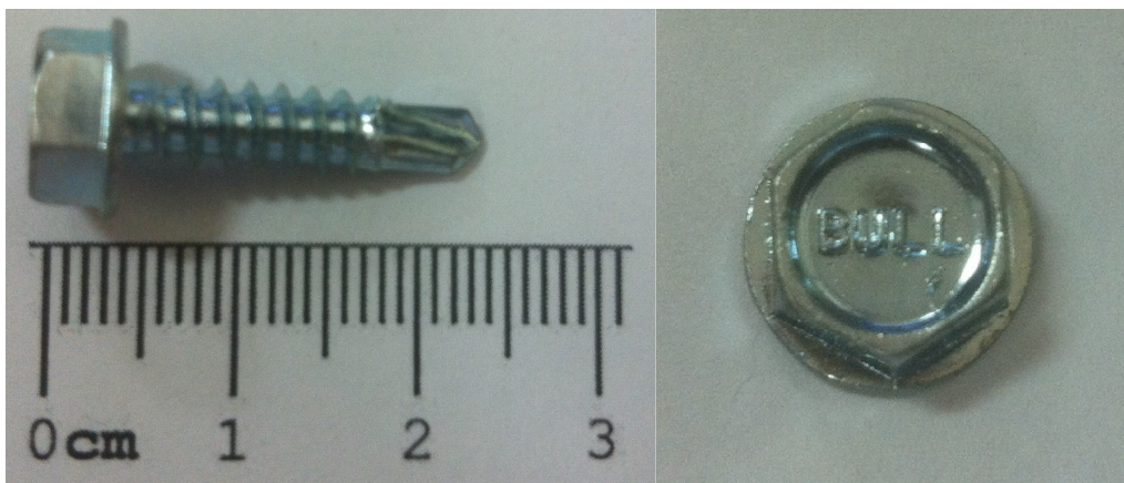
Figura 9 – Parafuso estrutural - cabeça sextavada e ponta broca.
