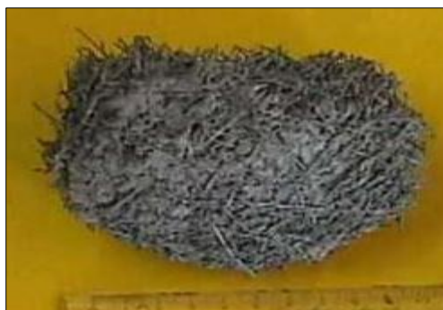
Figura 12 – Ouriço formado por agrupamento de fibras no concreto.
