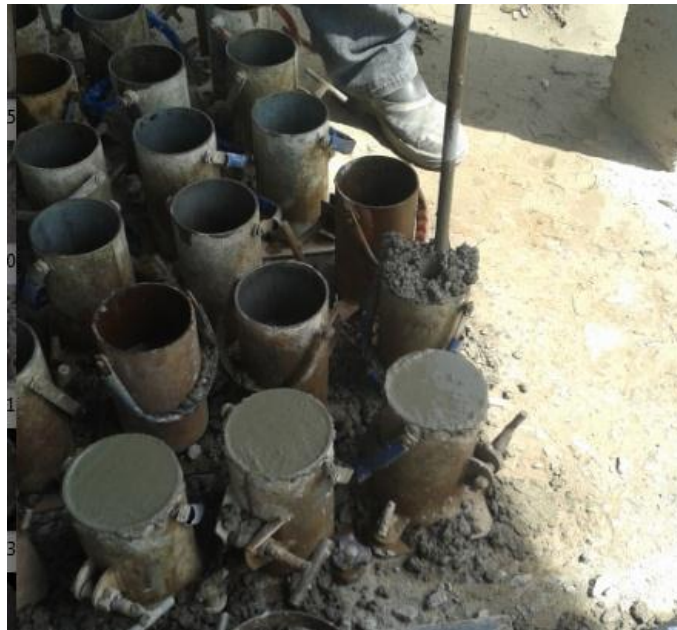
Figura 28 - Adensamento do concreto
