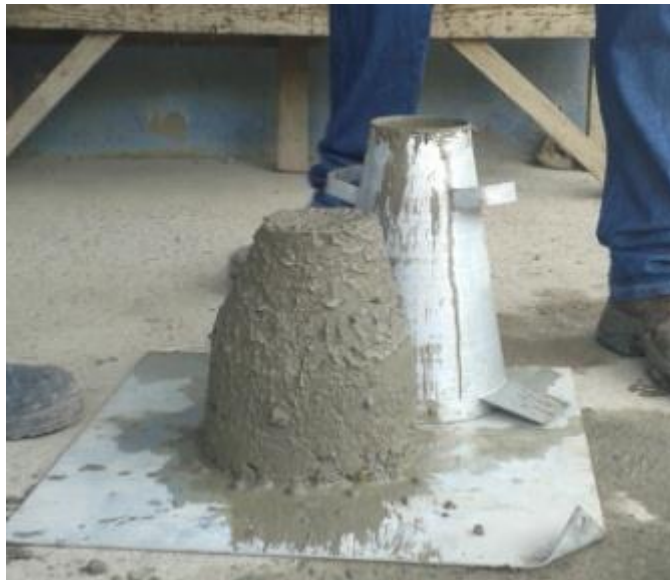
Figura 27 - Slump Test realizado no experimento
