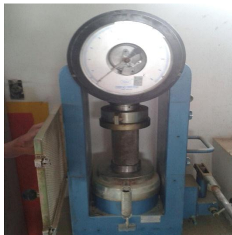
Figura 31 - Detalhe do rompimento do corpo de prova por compressão axial
