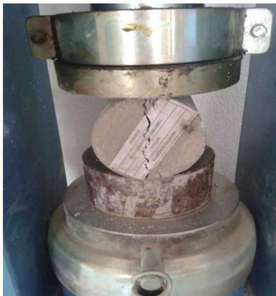
Figura 33 - Detalhe do rompimento de tração por compressão diametral
