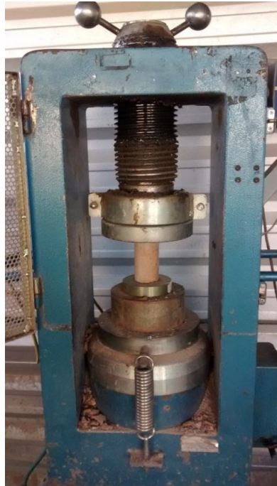
Figura 14 – Rompimento do corpo de prova com substituição de cimento por resíduo cerâmico
