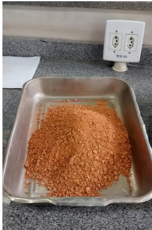
Figura 7 – Resíduo passante na peneira 4,5mm
