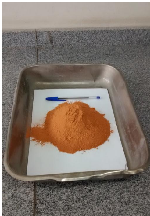
Figura 10 – Resíduo passante na peneira ABNT 200# (0,0075mm)
