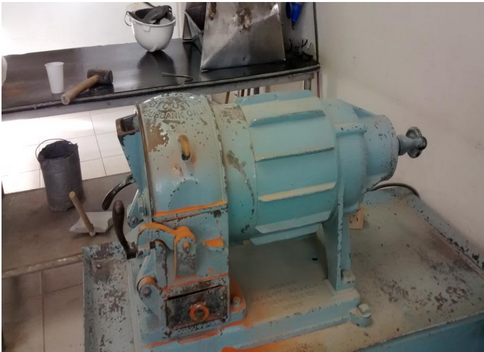
Figura 6 – Moinho tipo pulverizador de disco
