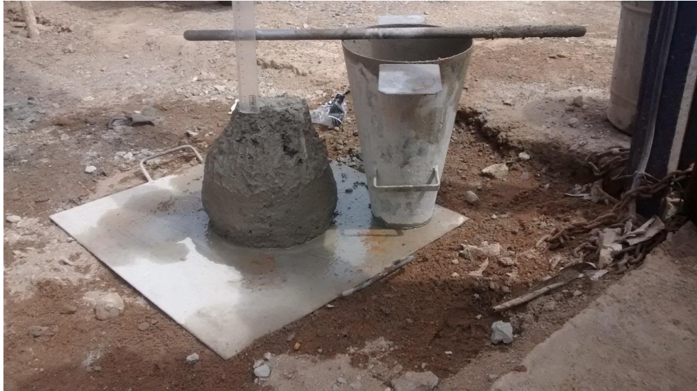
Figura 17 – Teste de Slump
