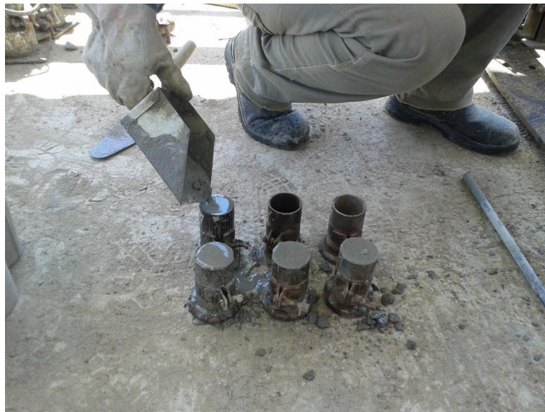
Figura 11 - Moldagem dos corpos de prova
