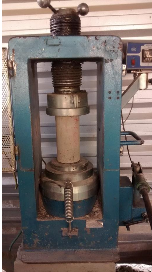
Figura 23 – Rompimento do corpo de prova
