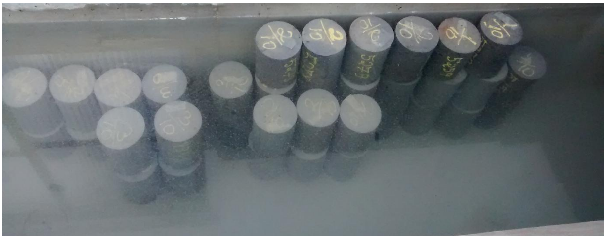
Figura 15 – Tanque com água onde são mantidos os corpos de prova após suas retiradas das fôrmas
