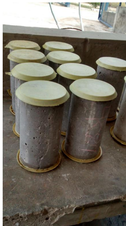
Figura 17 – Corpos de prova capeados com enxofre
