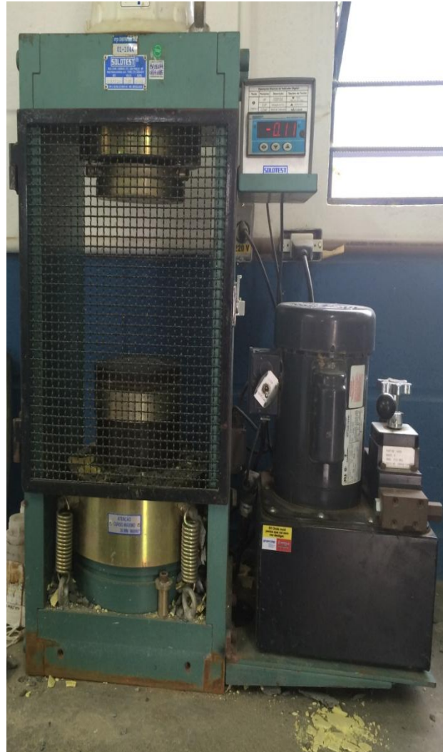
Figura 19 – Prensa hidráulica da fabricante Solotest para realização do ensaio de compressão axial
