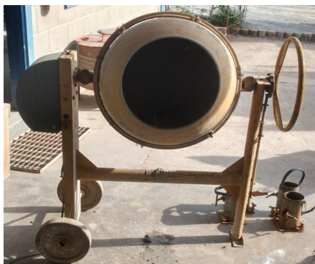
Figura 11 – Betoneira de eixo inclinado com capacidade de 120 litros
