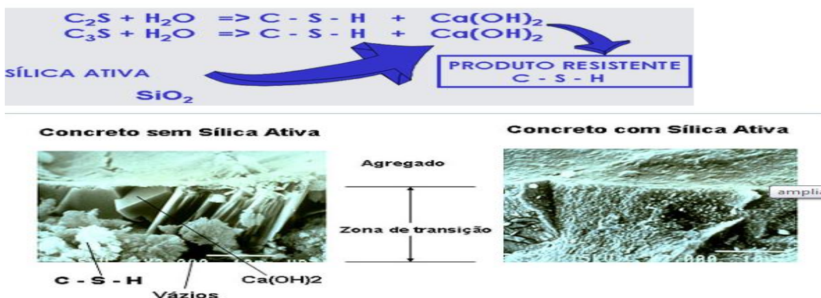
Figura 07 – Reação gerada pela sílica ativa e imagens de sua utilização ou não
