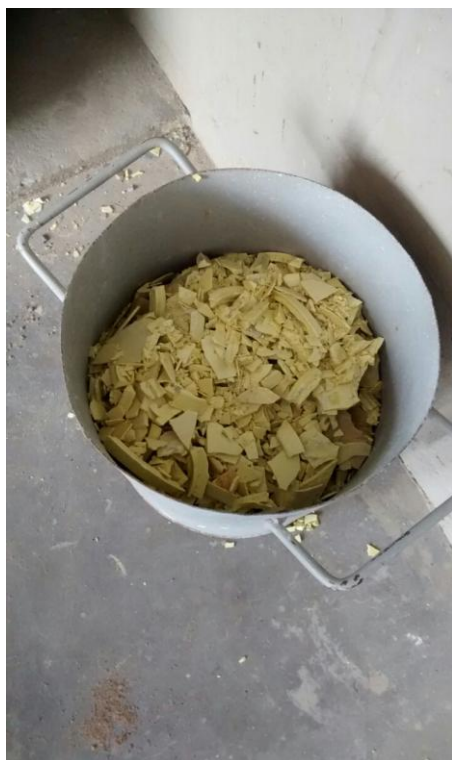
Figura 16 – Recipiente com enxofre sólido para capeamento
