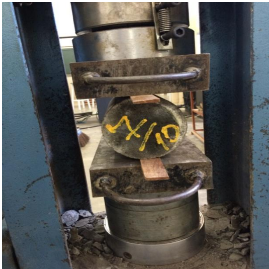
Figura 24 - Realização do ensaio de tração por compressão diametral
