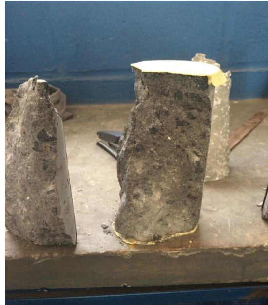
Figura 22 – Corpo de prova após realização do ensaio de compressão axial
