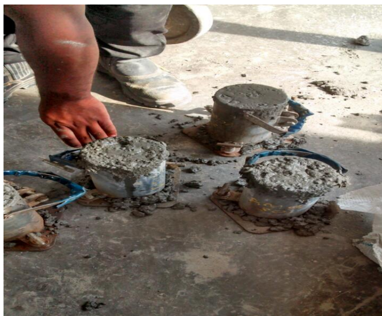
Figura 13 – O concreto após ser colocado nas fôrmas
