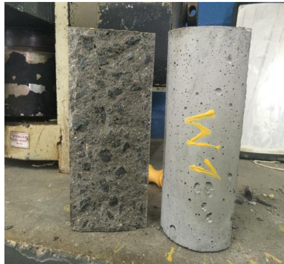
Figura 25 – Corpo de prova após realização do ensaio de tração por compressão diametral
