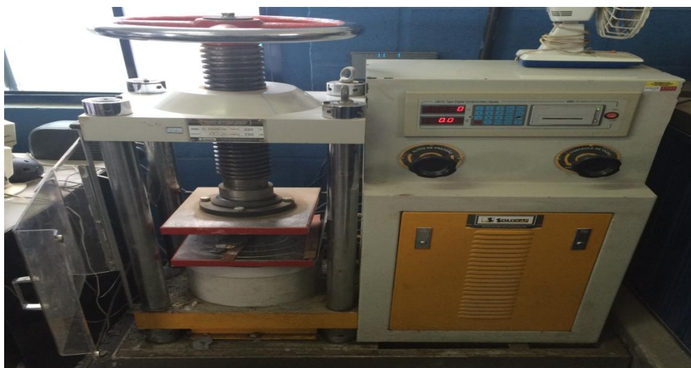
Figura 23 – Prensa hidráulica da fabricante Solocap para realização do ensaio de tração por compressão diametral
