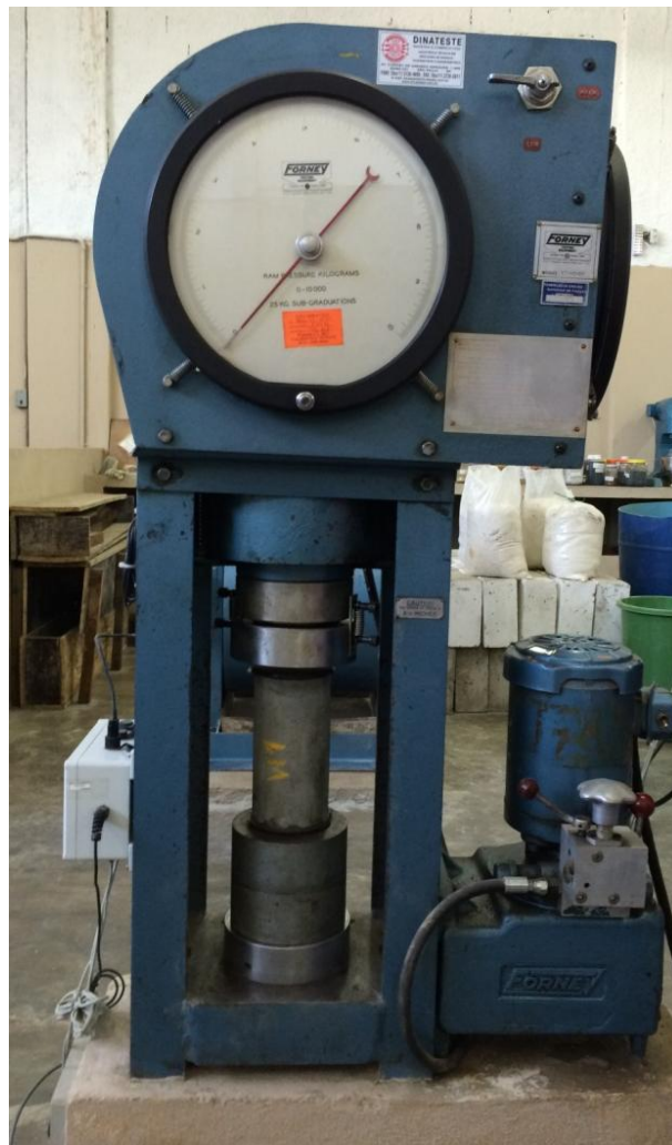
Figura 20 – Prensa hidráulica da fabricante Forney para realização do ensaio de compressão axial e também o de tração por compressão diametral
