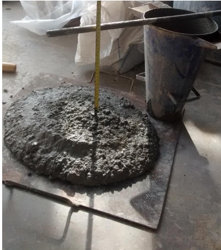
Figura 18 – Medição do abatimento do concreto
