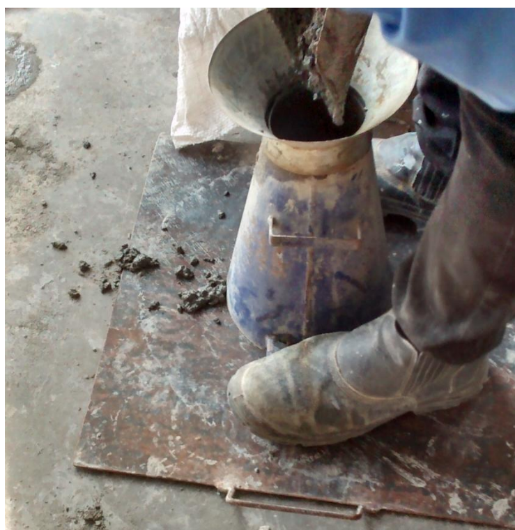
Figura 12 – Preenchimento do tronco de cone para realização do slump test
