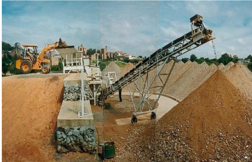
Figura 2 - Processo de triagem e moagem do RCD.
