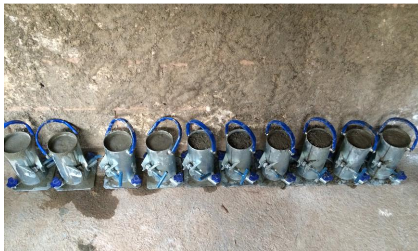
Figura 16 – Corpos de prova moldados
