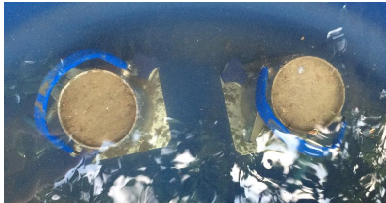
Figura 17 - Corpos de prova mergulhados no tanque com água.
