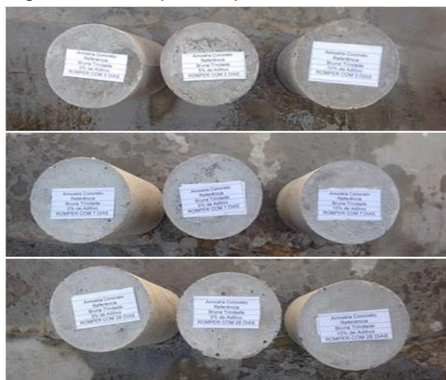
Figura 15 – Corpos de prova desenformados
