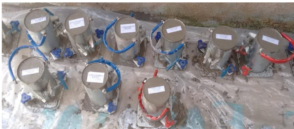
Figura 14 – Moldagem corpos de prova
