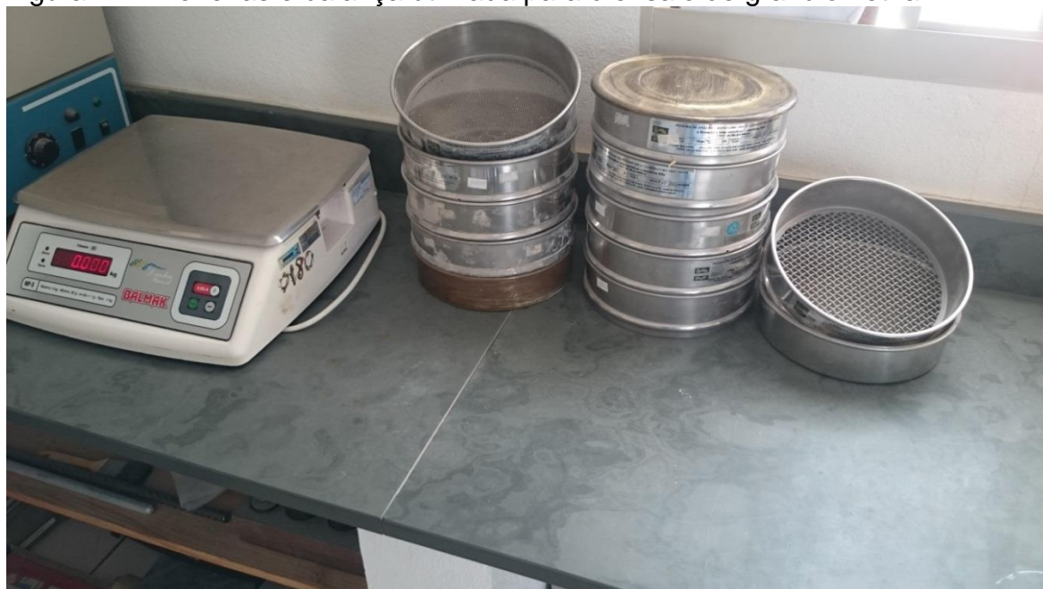
Figura 12 – Peneiras e balança utilizada para o ensaio de granulometria
