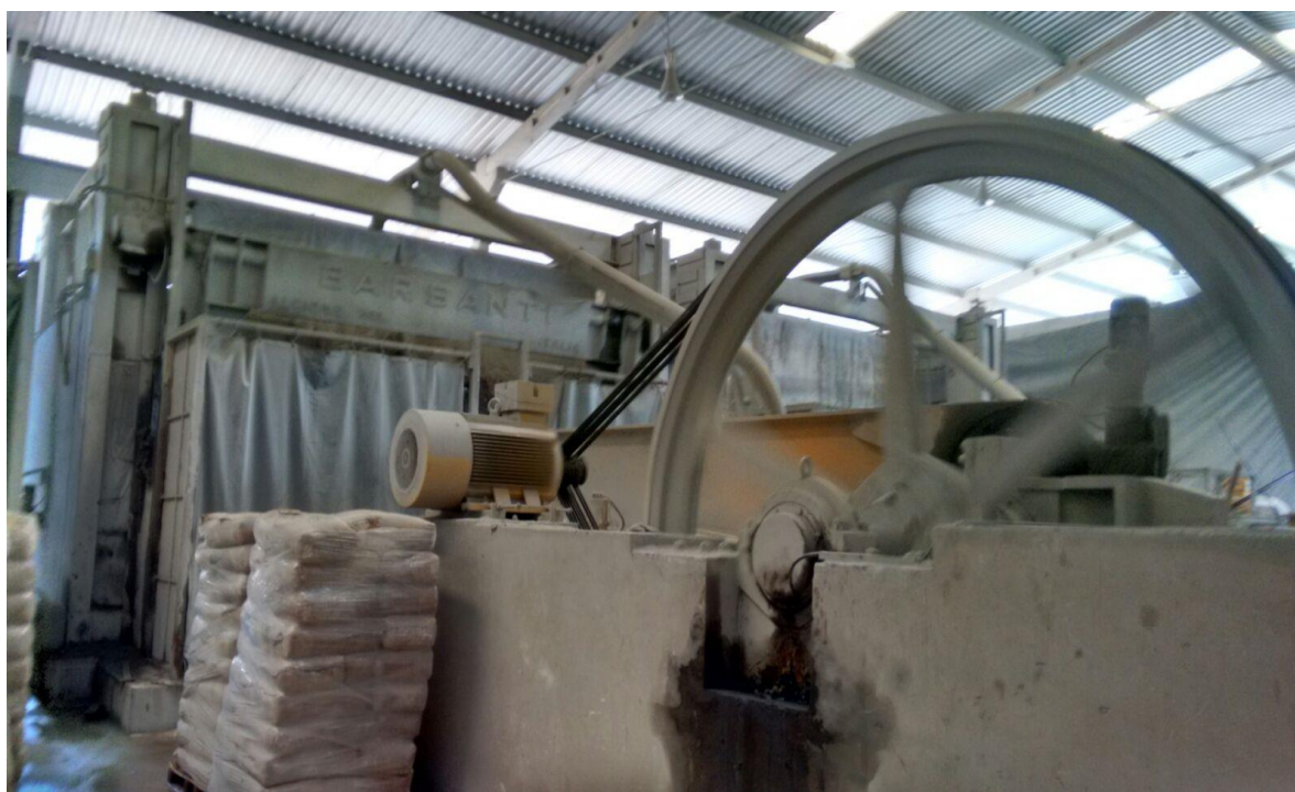
Figura 9- Equipamento utilizado para executar o corte dos blocos, denominado Tear
