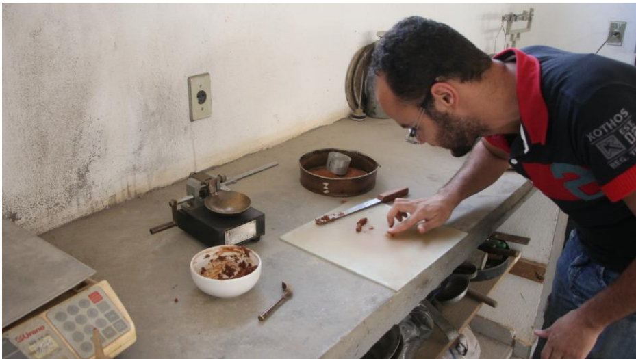
Figura 9 – Início do ensaio de limite de plasticidade
