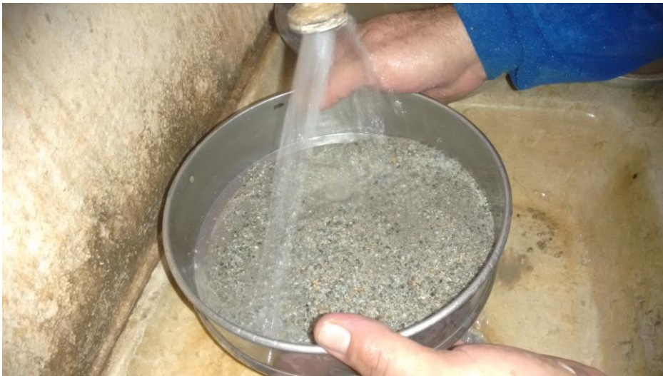
Figura 7 – Granulometria lavada de material britado
