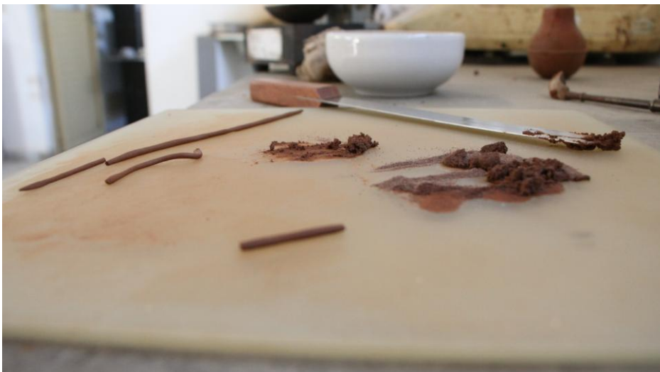
Figura 11 – Cilindro de solo com espessura de norma
