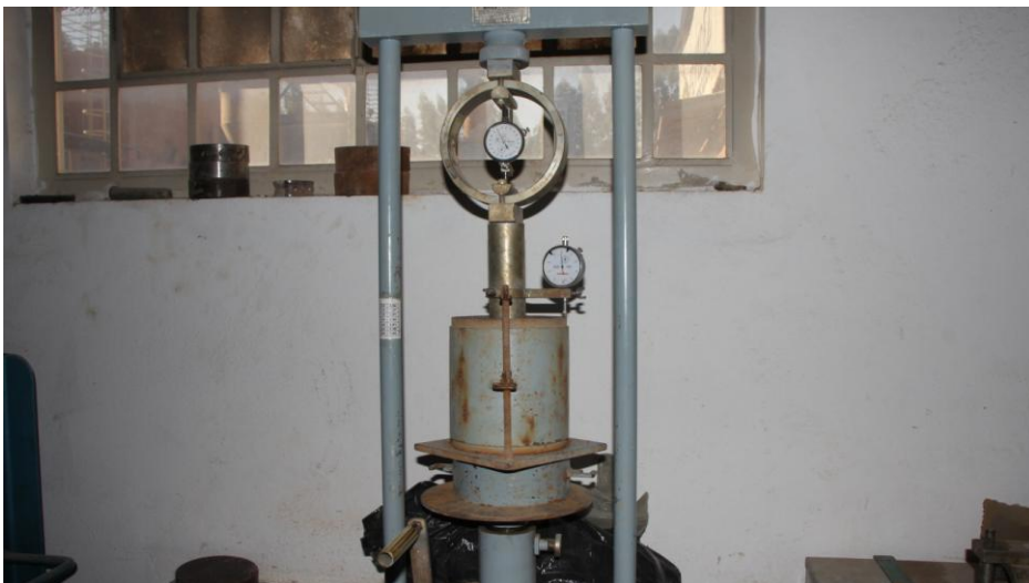
Figura 21 – Prensa de CBR
