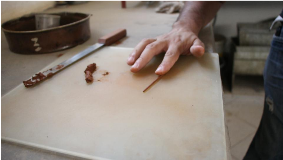
Figura 10 – Moldando o cilindro de solo para o limite de plasticidade
