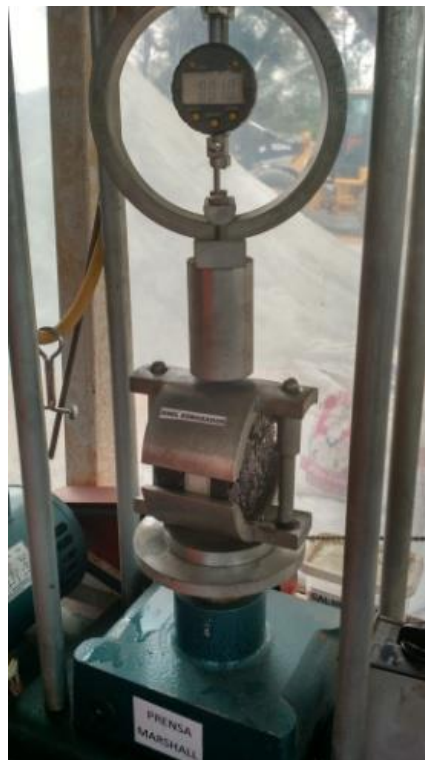
Figura 14 - Prensa para determinação da estabilidade Marshall
