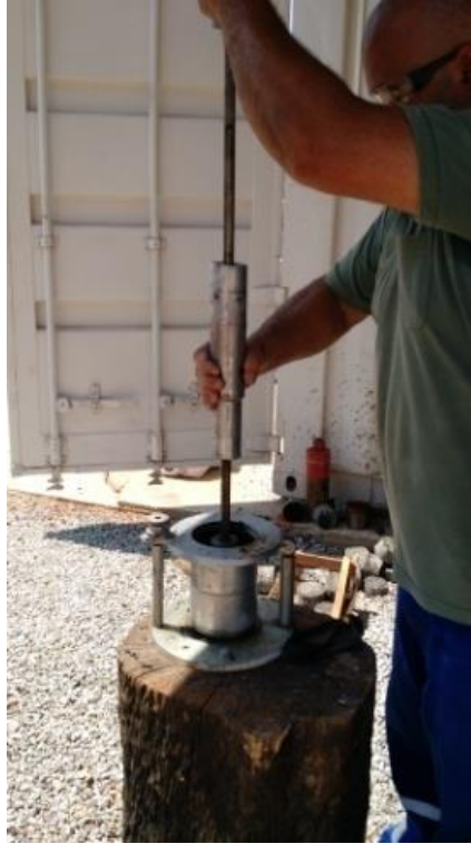
Figura 11 - Compactação dos corpos de prova
