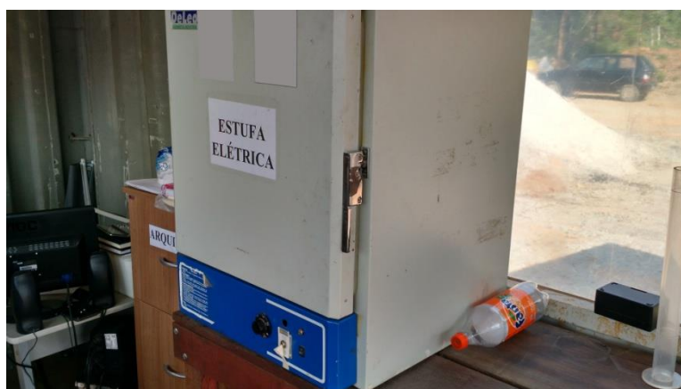
Figura 10 - Estufa para secagem dos agregados e aquecimento do CAP
