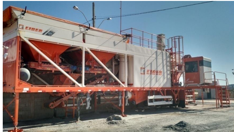
Figura 4 - Usina de asfalto volumétrica de contra fluxo
