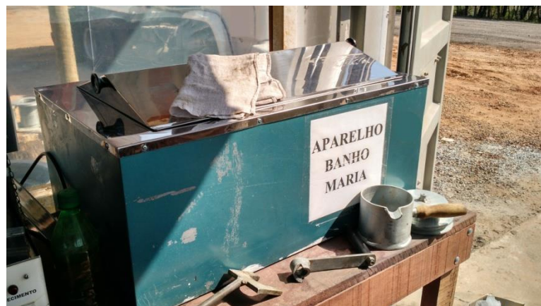
Figura 13 - Aparelho banho maria para aquecimento dos corpos de prova
