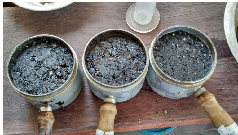
Figura 12 - Corpos de prova compactados
