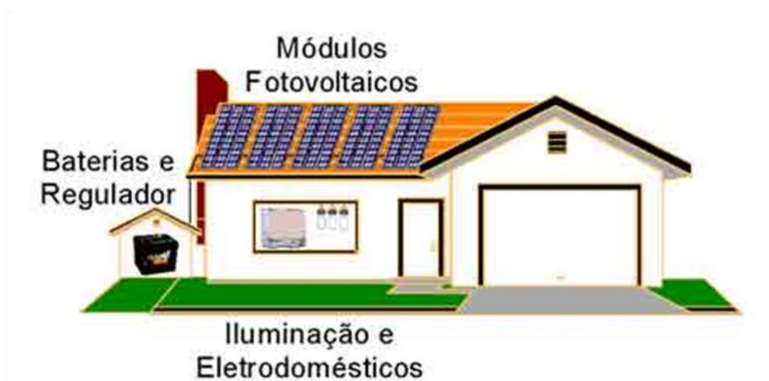
Figura 5 - Esquema de um sistema fotovoltaico autônomo.
