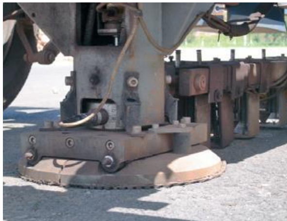
Figura 7 - Detalhe do prato de aplicação de carga e da barra de sensores
