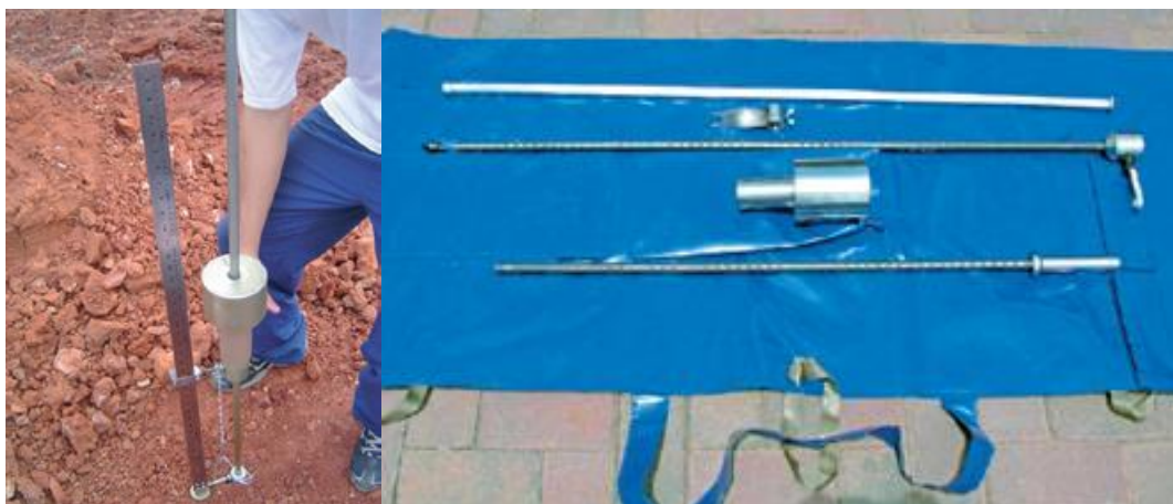
Figura 3 - Equipamentos DCP de avaliação estrutural
