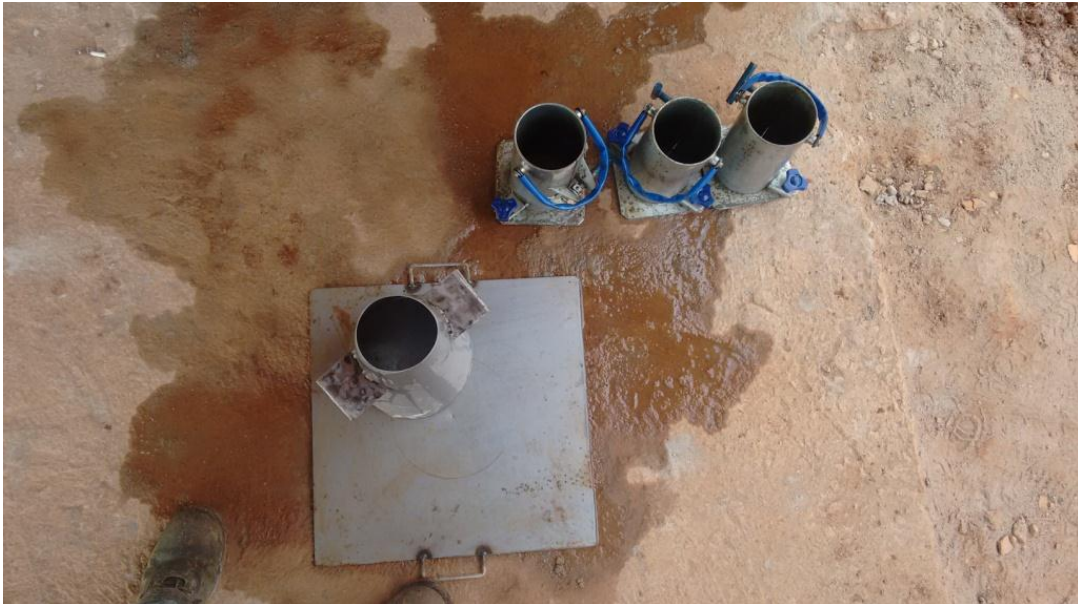
Figura 10 – Conjunto do Slump Test , preparado para o ensaio
