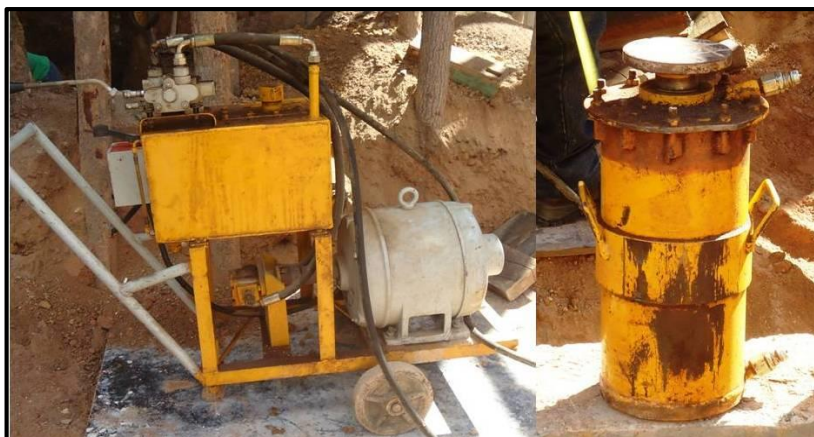
Figura 20 - Pistão hidráulico e bomba hidráulica
