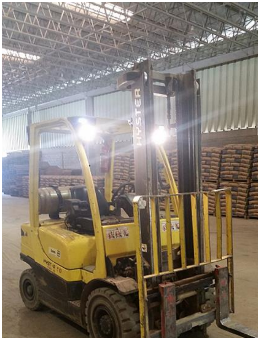
Figura 3 – Máquina equipada de componentes de proteção coletivas.
