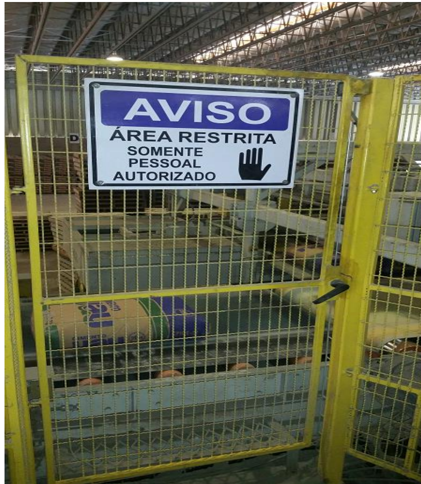
Figura 4 – Grade de isolamento em equipamento.
