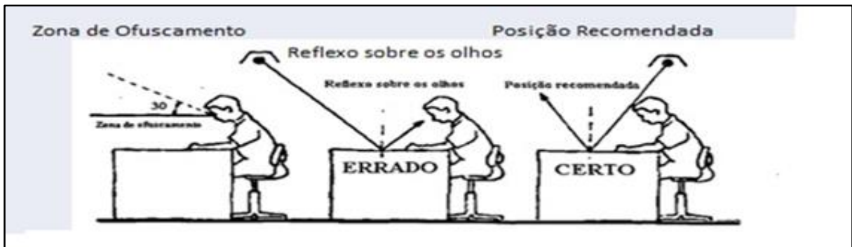
Figura 2 - Posicionamento das luminárias
