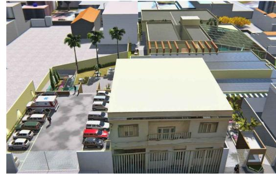
O projeto foi desenvolvido em **dois níveis**, sendo o considerado o **nível 0.00** a cota **101** e no **estacionamento** dois metros acima **nível 2.00** a cota **103**. Para isso foi feito um pequeno aterro na fachada principal e um corte no terreno na área do pátio externo próximo ao restaurante e estacionamento.
