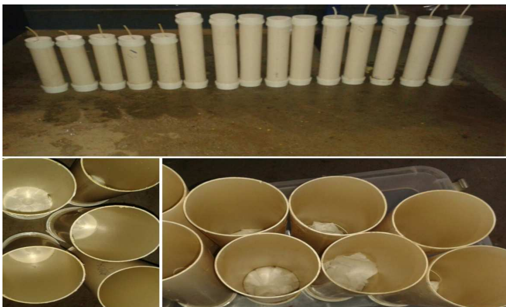
Figura 7 – Canos de PVC utilizados para a ensilagem
