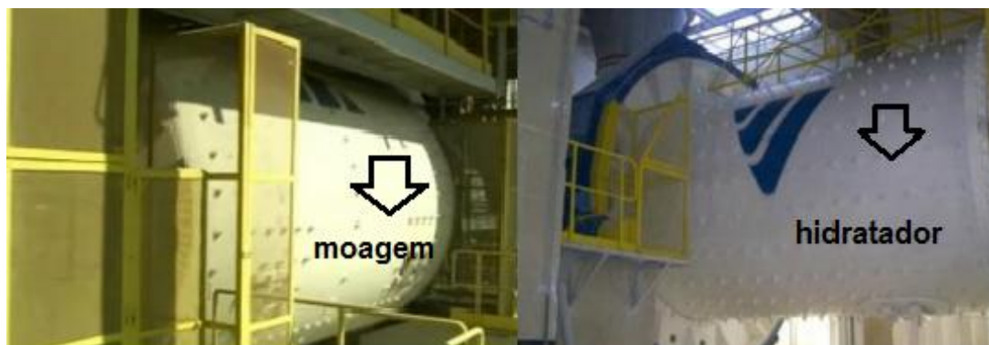
Figura 5 - Moagem em moinho bola e hidratador respectivamente
