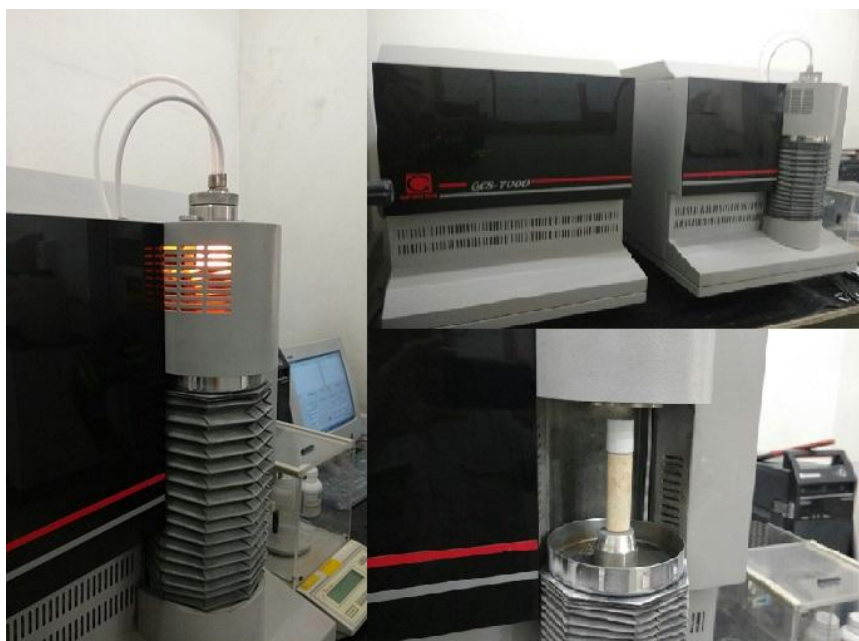
Figura 10 - Análises de anidrido carbônico no aparelho de detector de infravermelho não dispersivo.
