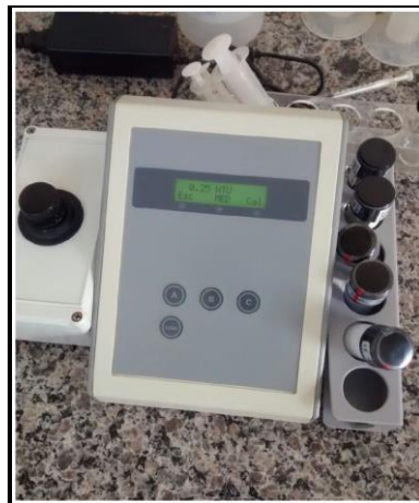
Figura 17 - Turbidímetro de bancada digital e um kit padrão de turbidez
