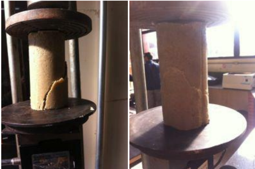
Figura 10 - Ruptura do corpo de prova CP_1 após tratamento do solo.
