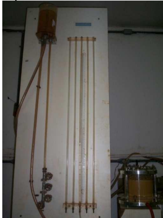
Figura 23 – Montagem do ensaio de permeabilidade para o perfil de solo da voçoroca de Santa Maria.
