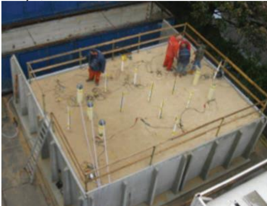
Figura 26 – Montagem do ensaio de tratamento do solo por Paassen (2010): circulação dos fluídos através da areia entre os três furos de injeção, à esquerda e os três furos de extração, à direita.
