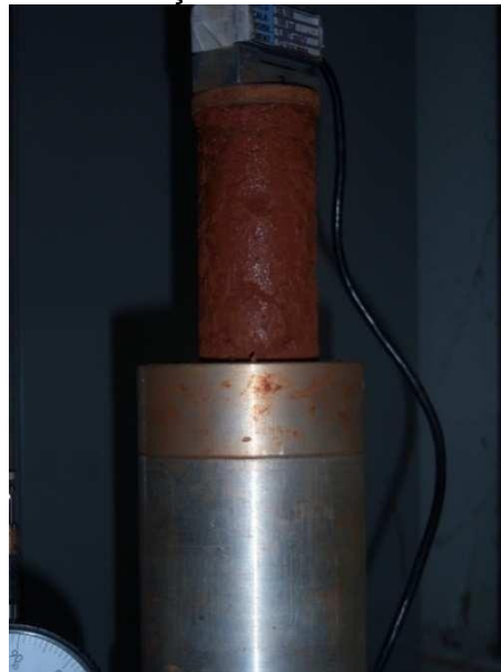
Figura 21 - Ensaio de resistência à compressão simples do perfil de solo da voçoroca de Santa Maria.
