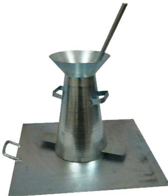
Figura 5 - Equipamento para o Ensaio de Abatimento do Tronco de Cone
