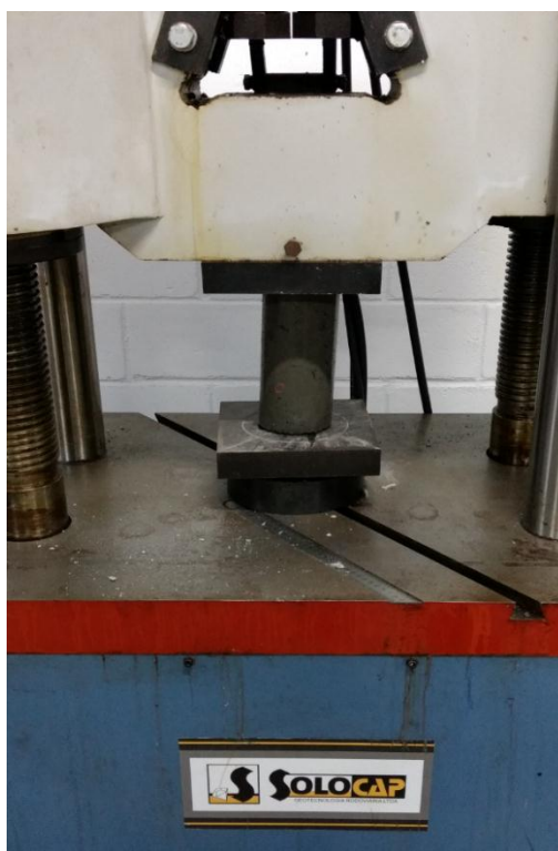
Figura 24 - corpo de prova a ser rompido
