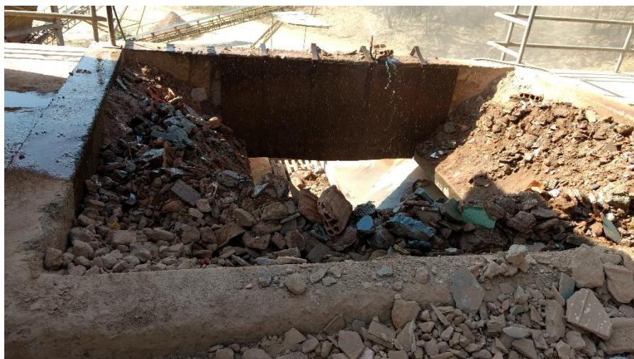
Figura 10 - Material triado disposto no alimentador
