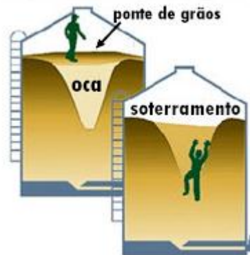
Figura 28 – Soterramento por colapso de pontes de grãos
