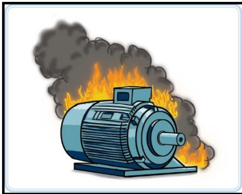
Figura 14 – Incêndio classe C
