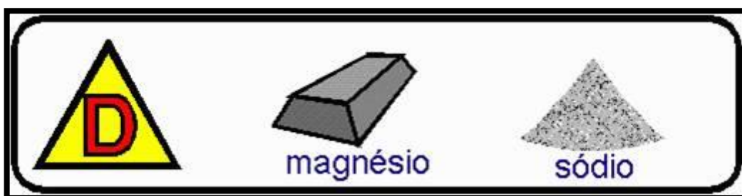
Figura 15 – Incêndio classe D
