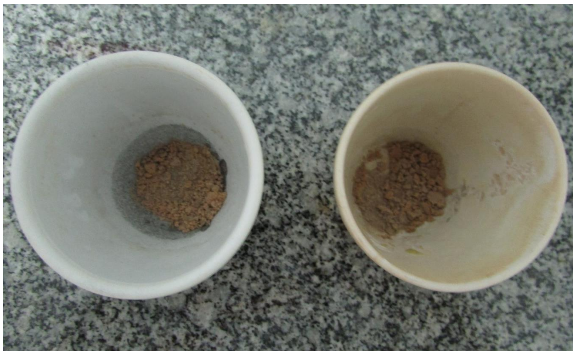
Figura 16 - Amostra de pólvora negra depois de calcinada
