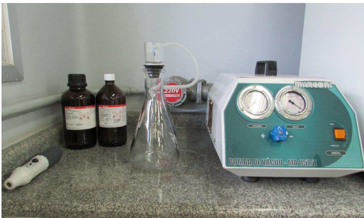
Figura 15 - Amostra de pólvora negra depois de lavada com dissulfeto de carbono e com álcool etílico através de filtração a vácuo
