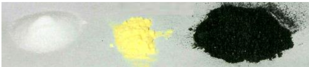
Figura 4 - Matérias-primas de pólvora negra tipo A: Nitrato de potássio, enxofre super ventilado e Carvão vegetal
