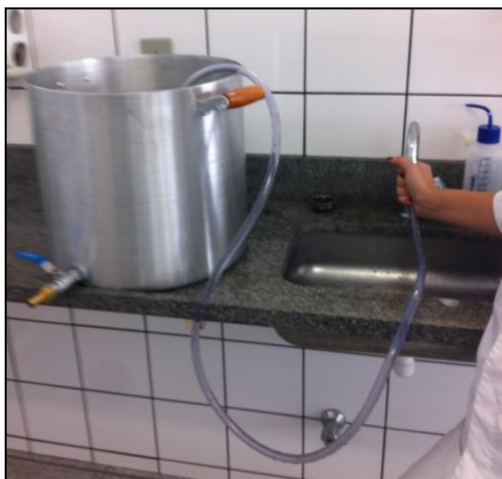
Figura 27 - Chiller conectado a torneira
