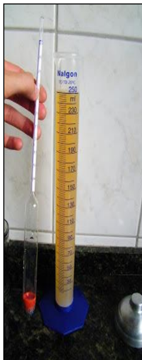
Figura 31 - Medição da densidade
