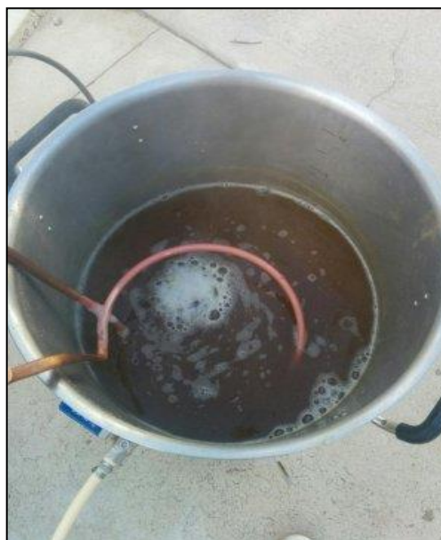
Figura 14 - Resfriamento utilizando o chiller imerso no mosto
