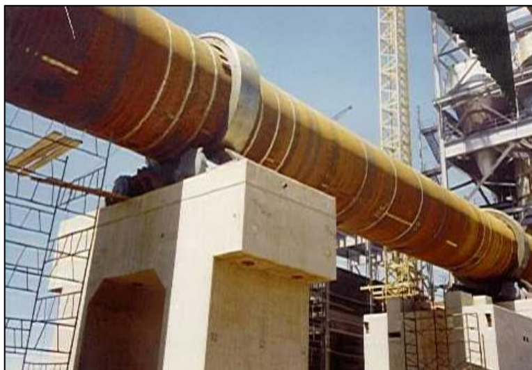
Figura 6 - Forno rotativo de clínquer
