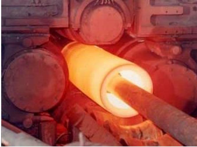
Figura 11 – Perfuração de tubos de aço sem costura longitudinal
