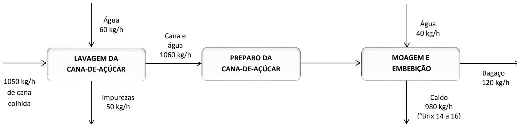
Figura 18 - Esquema do balanço de massa na extração do caldo de cana
