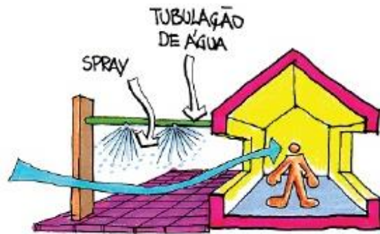
Figura 12 - Sistema de aspersão aplicado na área externa.
