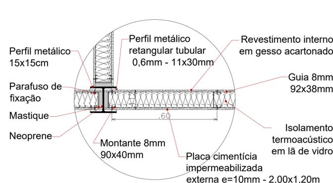
DETALHE 06 - LIGAÇÃO VIGA-PILAR: PERFIS I | ESCALA 1:10
