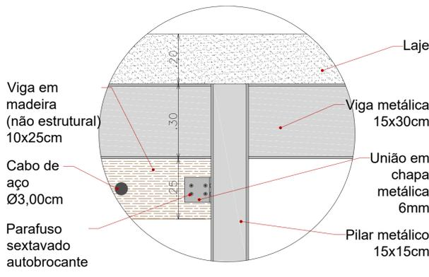
DETALHE 05 - FIXAÇÃO DRYWALL | ESCALA 1:10
