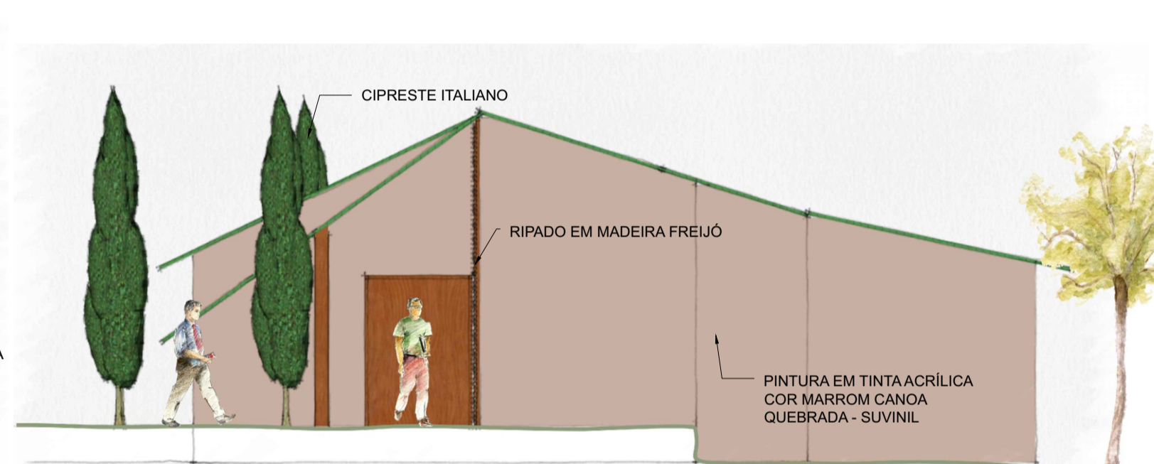
FACHADA LATERAL DIREITA - RECEPÇÃO ESCALA: 1/75
