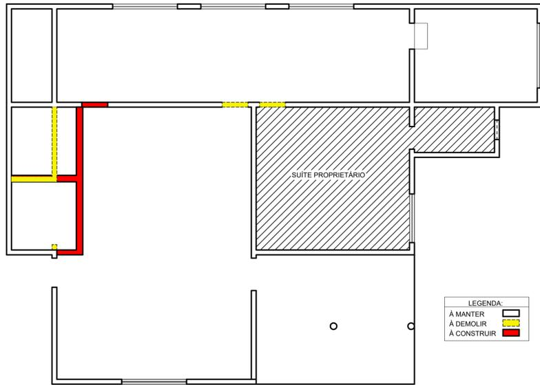
**RECEPÇÃO E ADMINISTRAÇÃO - PLANTA DE DEMOLIÇÃO E CONSTRUÇÃO**
