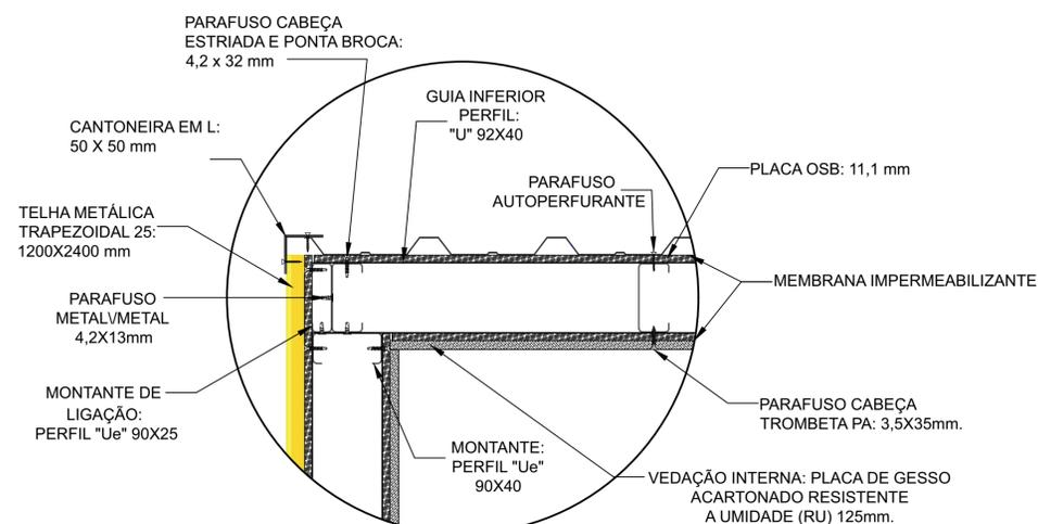
DETALHE 03: ENCONTRO DOS PERFIS E FIXAÇÃO DAS PLACAS DE VEDAÇÃO | ESCALA 1/5
