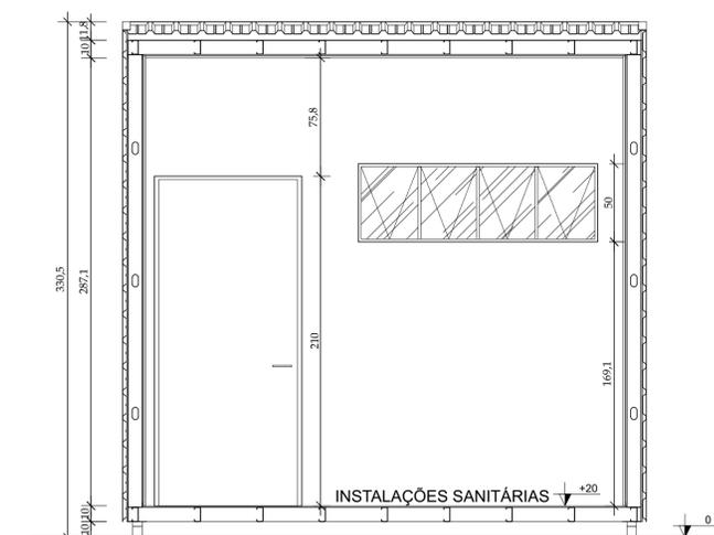
CORTE LONGITUDINAL BB | ESCALA 1/25
