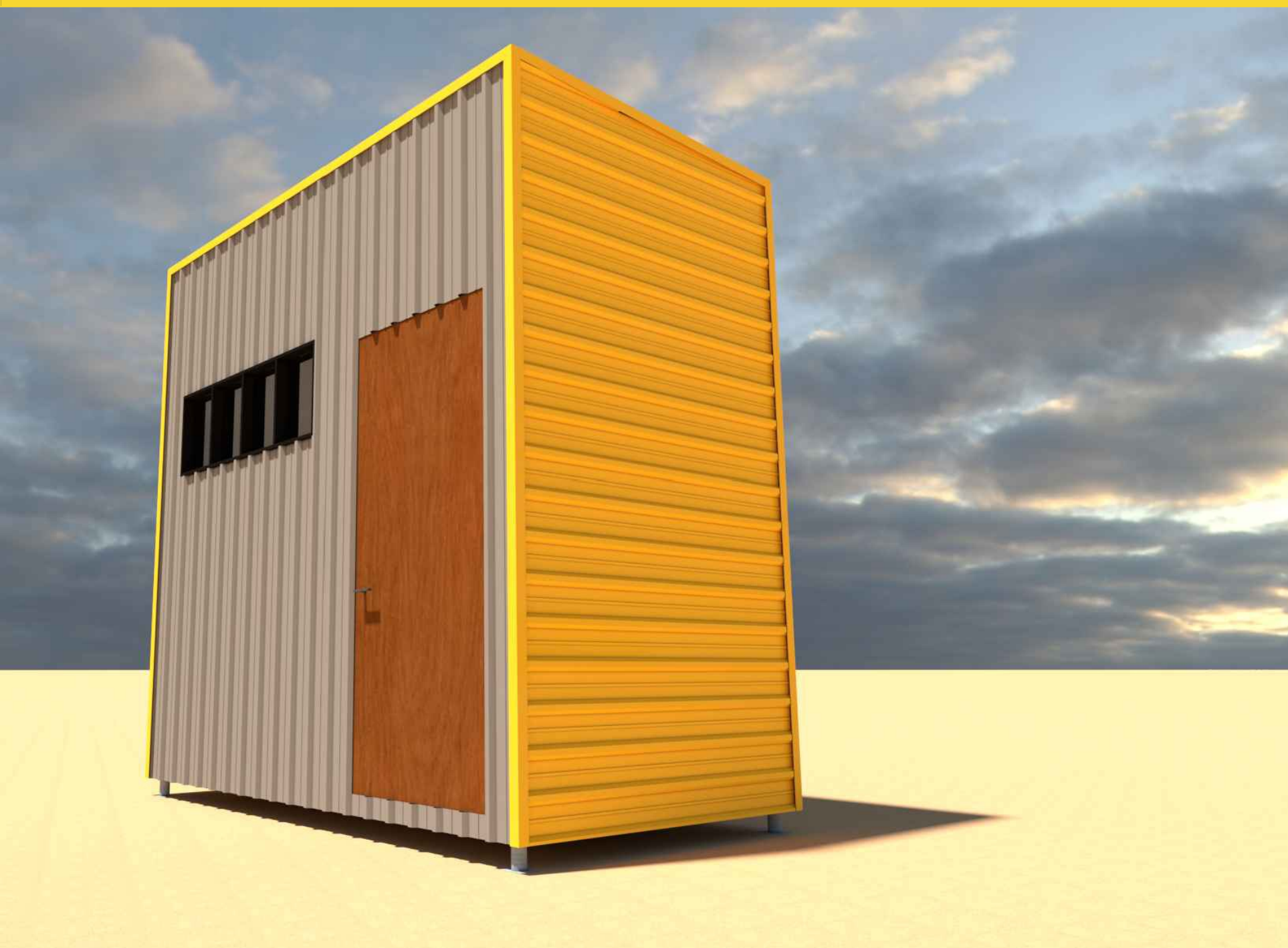
BASE AJUSTÁVEL ATRAVÉS DE ROSCA PARA NIVELAMENTO DO MÓDULO EM CASO DE TERRENO COM DESNÍVEL.
