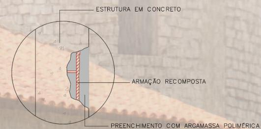
RECUPERAÇÃO DA ESTRUTURA EM CONCRETO ARMADO COM ARGAMASSA POLIMÉRICA
