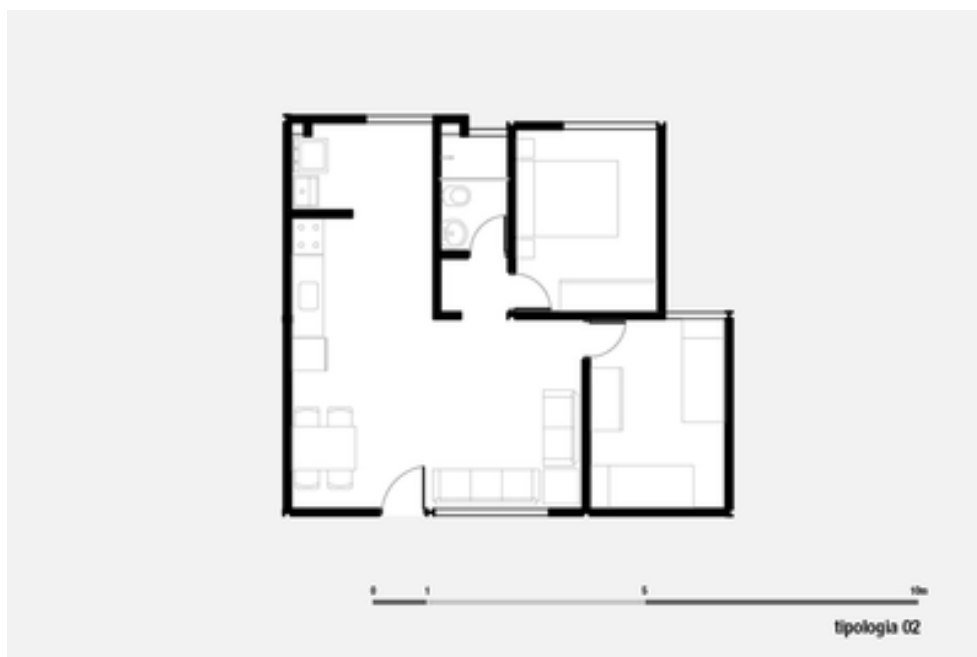
Figura 24 - Opção 2: Planta Baixa com 2 quartos e cozinha/ sala de jantar/ sala integrados
