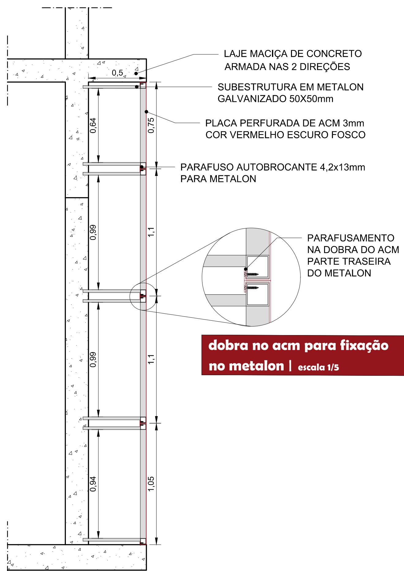
detalhe 4 - fixação placa perfurada em acm | escala 1/20
