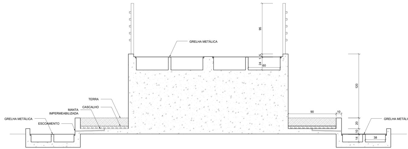
DETALHE GRELHAS DE CAPTAÇÃO DE ÁGUA PLUVIAL RAMPA - CORTE
