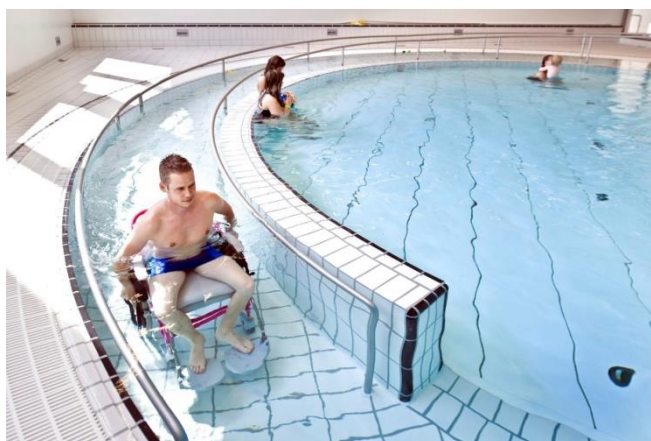
Figura 28 - Sistema de rampas dentro das piscinas
