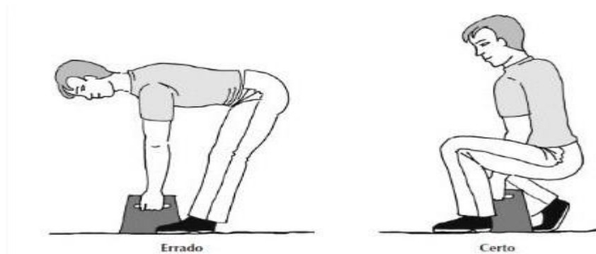
Figura 19 - Condição correta e errada no manuseio de material
