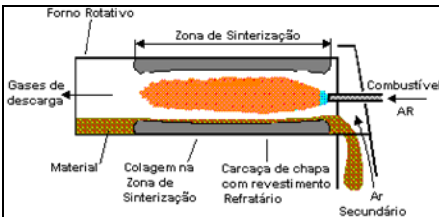
FIGURA 18 - Representação esquemática da saída do forno e a chama.
