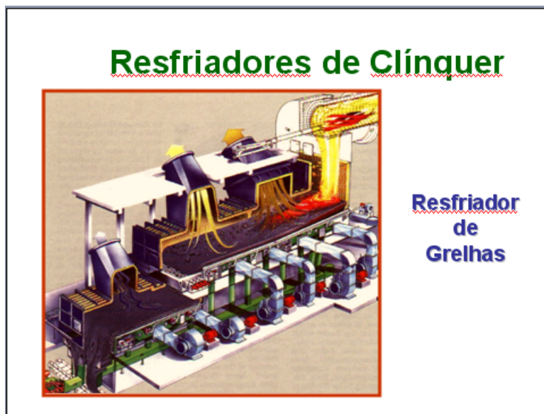
FIGURA 9 – Sistema de Arrefecimento de grelhas.
