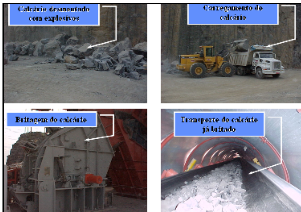
FIGURA 2 - Processo de extração de calcário.
