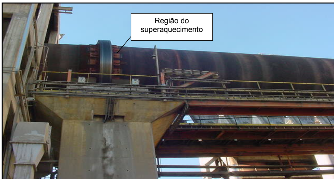
FIGURA 28 - Forno rotativo – em destaque a base de rolamento (aliança).
