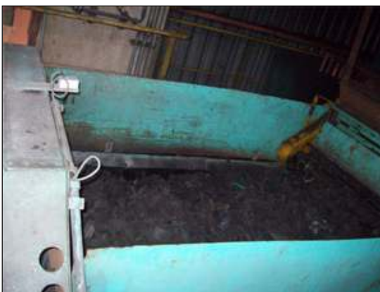
Figura 35: Balança dosadora de blend Fonte: Lafarge – Arcos 2009
