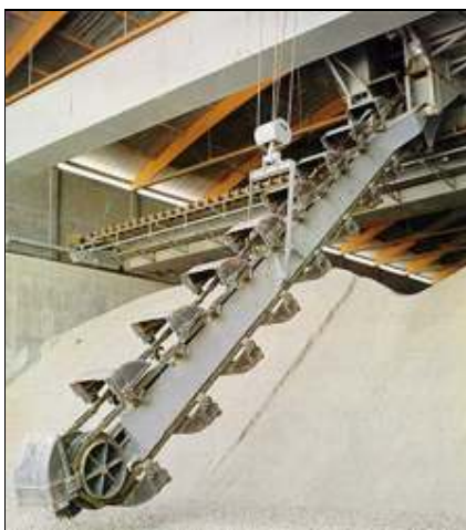
Figura 10 – Retomadora de argila tipo alcatruz Fonte: VOTORANTIM CIMENTOS, 2000
