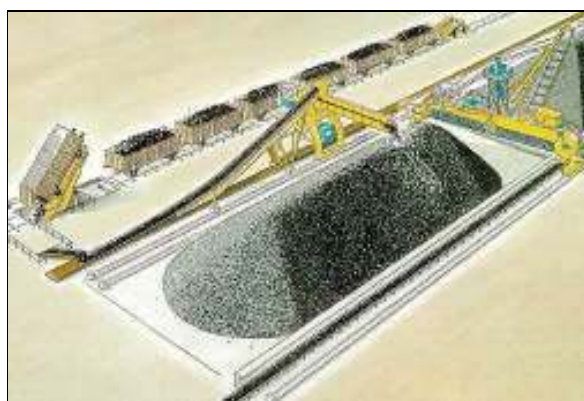
Figura 15 – Sistema de estocagem e retomada de coque Fonte: VOTORANTIM CIMENTOS, 2000.
