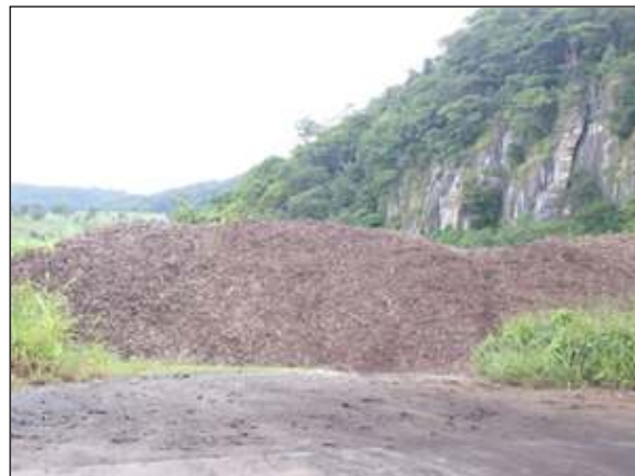
Figura 29: Estoque de chip de pneu Fonte: Lafarge – Arcos 2009
