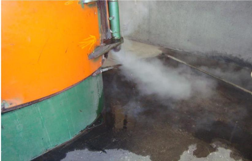
**Figura 16** Máquina de vulcanização de pneus fora de estrada
